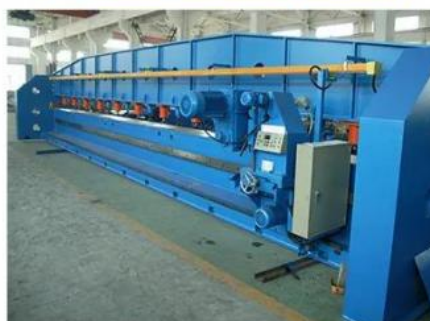
Automatic edge milling machine
